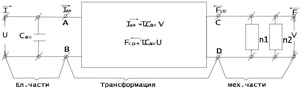
Фиг. 2. Еквивалентна електрическа схема на твърда пиезокерамична схема
