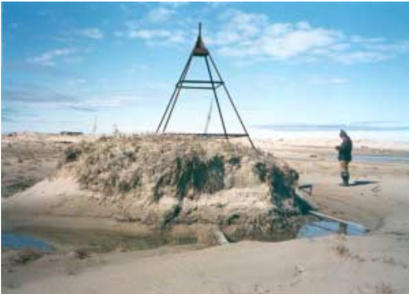
Рис. 5. Поверхность берегового бара о. Варандей за период освоения местами стала ниже на 1 - 3 м в результате воздействия дефляции, термоэрозии и термокарста
