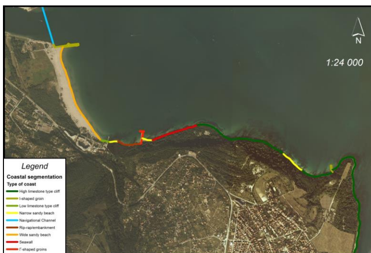
Фиг. 14. Фрагмент от карта на брегова сегментация (Stanchev et al., 2013)
